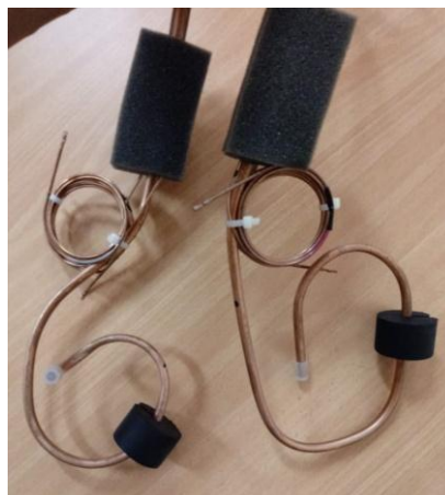
Gambar 1. Damper Pipe pada pipa kompresor
